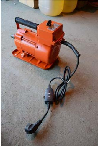
Глубинные вибраторы **ВЕКТОР-2200** представляют собой электромеханическую ручную модель общего назначения, оборудованную гибким валом. Этот портативный глубинный вибратор разработан для уплотнения бетона при создании армированных и монолитных конструкций.
